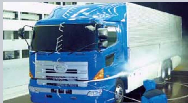
الختبارات الانسيابية الهوائية باستعمال طراز مقياس 1/1 ( مقياس كامل ) Aerodynamic tests using a 1/1 scale (full-scale) model
