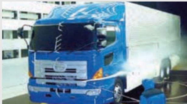
الاختبارات الانسيابية الهوائية باستعمال طراز مقياس 1/1 (مقياس كامل) Aerodynamic tests using a 1/1 scale (full-scale) model
