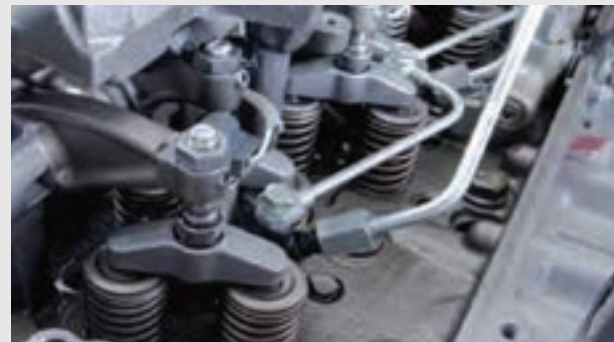
أربعة صمامات متعددة Four multiple valves
